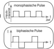
Im Digital TENS/EMS finden sich ausschließlich biphasische Pulsströme, da sie den Muskel entlasten, zu einer geringeren Muskelermüdung sowie zu einer sichereren Anwendung führen.
